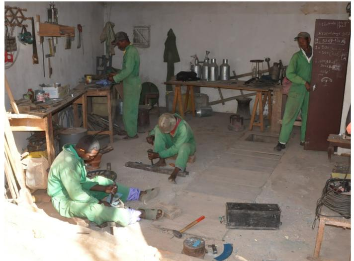
Fig. 2 : L'atelier de fer-blanterie : fer martelé et riveté (aucune soudure n'est pratiquée)
